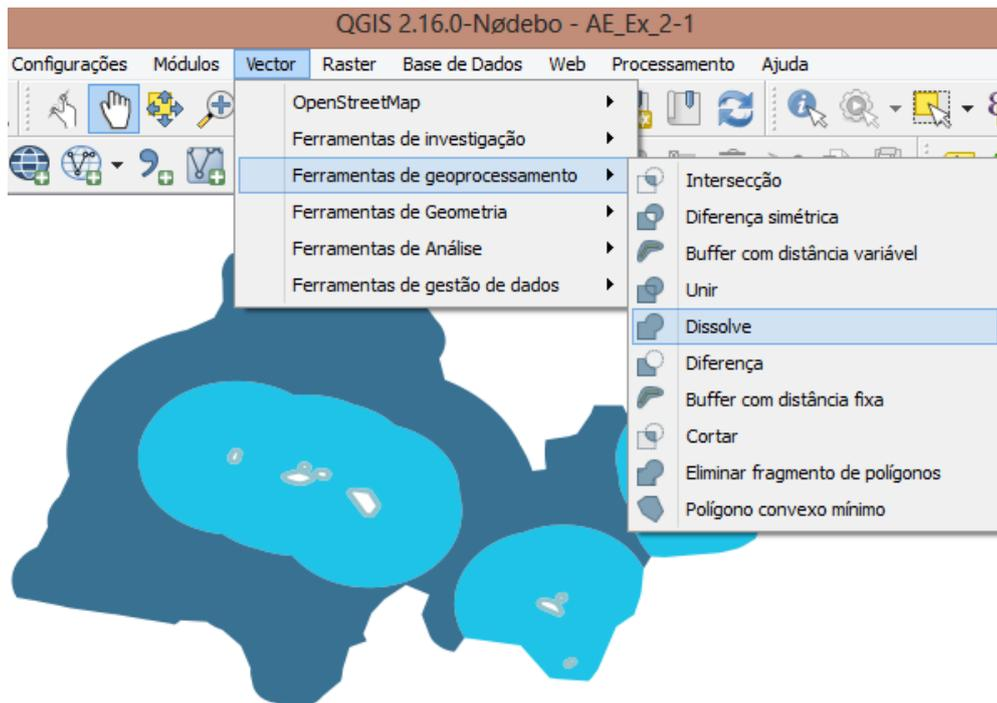
Figura 3 - Ferramenta para “dissolver” diferentes registos – *Dissolve*.
